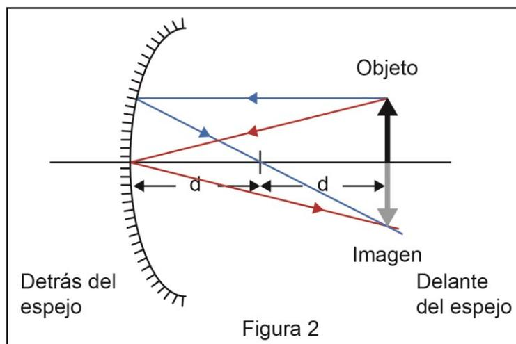
En la opción C), el objeto está ubicado a una distancia entre  $d$  y  $2d$  de un espejo cóncavo de distancia focal  $d$ , por lo que al realizar el trazado de rayos se consigue lo representado en la figura 3.
