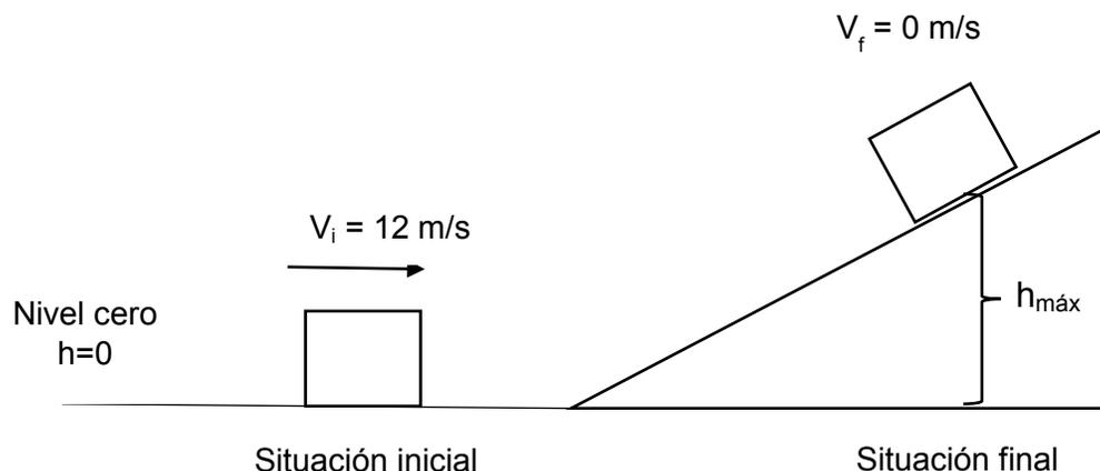
Debes recordar que la energía mecánica  $E_M$  de un cuerpo es la suma de la energía cinética  $E_C$  y la energía potencial que, en este contexto, es la energía potencial gravitatoria  $E_P$ .
