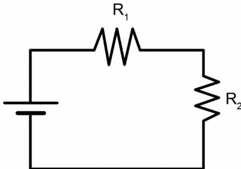
Considerando que la diferencia de potencial a la que se encuentra el circuito es  $12 \text{ V}$  y que la corriente eléctrica que circula por él tiene una intensidad de  $4 \text{ A}$ , ¿cuál es la resistencia eléctrica de  $R_2$ ?
