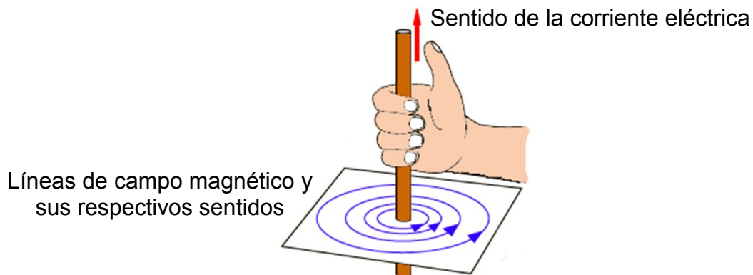
Figura 1: representación de la regla de la mano derecha para un campo magnético en torno a un alambre.
